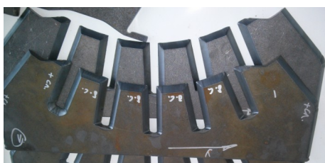
Фиг.4.: Деталь со сложными наклонами: проект-вверх и тестовая деталь-вниз
